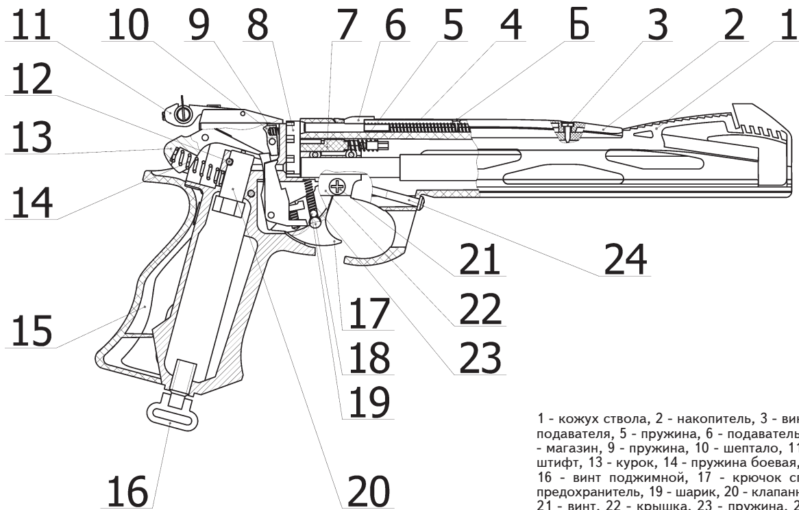
Рисунок А.2 – Схема механизмов пистолета
